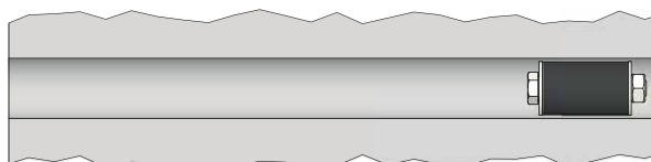
Setzen der Blindpacker am Lochanfang | Mise en place des obturateurs au début du trou
